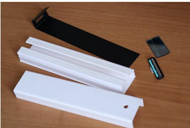
Сначала изготовим основу инструмента - дифракционную решетку. Её роль выполняет прямоугольник, вырезанный из компакт-диска. Компакт-диск можно использовать любого типа - CD, DVD, CD-R/RW или DVD-R/RW, но лучше взять незаписываемый CD или DVD с зеркальной рабочей поверхностью - такой диск лучше отражает свет и не будет вносить цветовых искажений.
