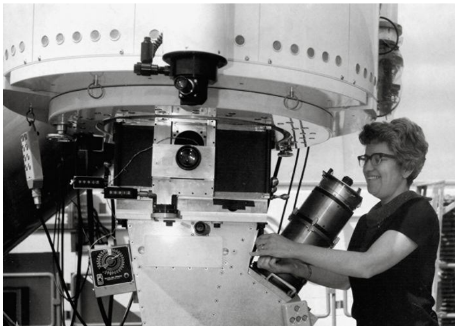
Вера Рубин у 84-дюймового телескопа обсерватории Китт Пик. Металлический цилиндр рядом с ней — спектрограф Форда. Фото с сайта astronomy.com
