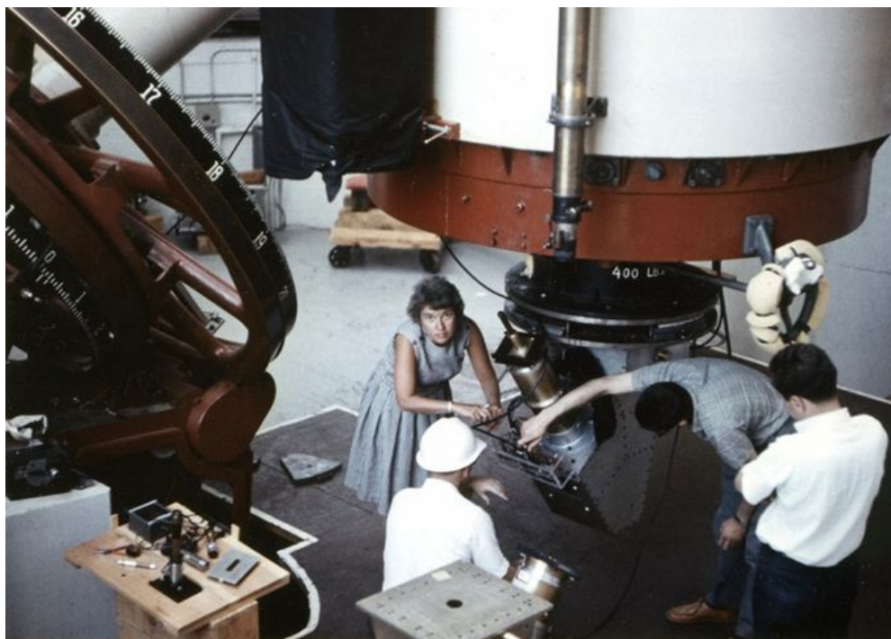
Вера Рубин и Кент Форд (человек в белой каске) проверяют установку изобретенного Фордом спектрографа на большом телескопе Лоуэлловской обсерватории, 1965 год. Фото с сайта astronomy.com
