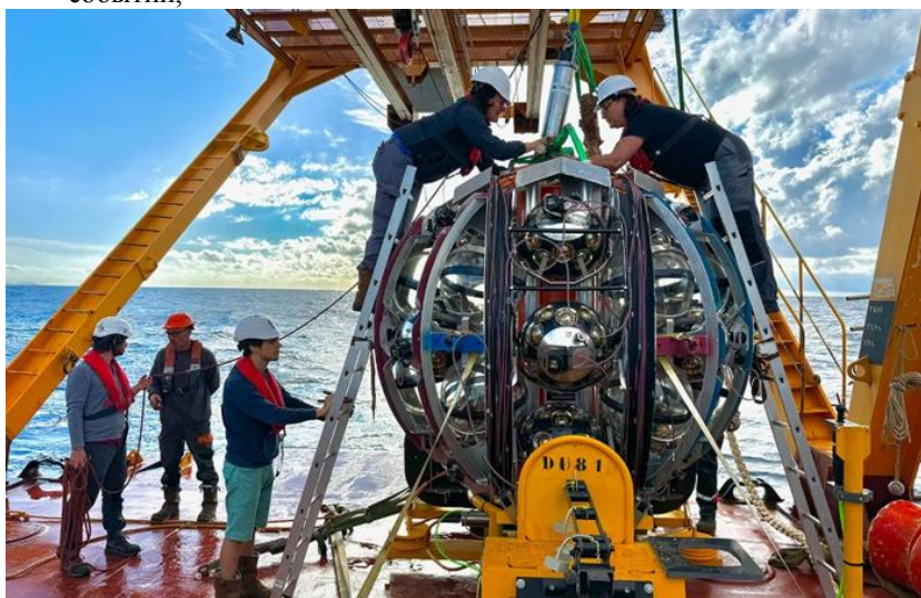
Рис. 2. Специалисты готовят к спуску на трехкилометровую глубину очередную гирлянду оптических модулей для строящегося у берегов Сицилии нейтринного телескопа KM3NeT. Фото из популярного синопсиса на сайте nature.com
